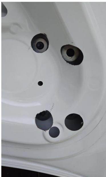
写真のようにトランク裏面にワッシャーや工具が入るように穴あけ加工を行ってください。
